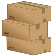
EMPILHAMENTO COLUNAR DESALINHADO
