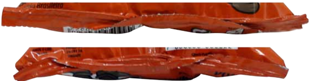
Exemplo de problemas de selagem numa embalagem flexível.
